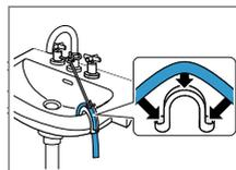
Fissare e assicurare il raccordo di scarico dell'acqua con un collettore.
