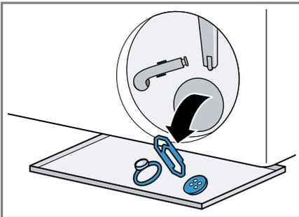
3. Accertarsi che l'elica della pompa di scarico possa ruotare.
