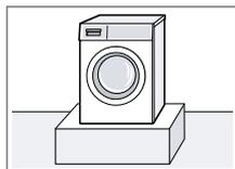
Fissare l'apparecchio con delle linguette di fissaggio → *Pagina 31*.
