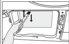
Sarà possibile usare un aspirapolvere con una spazzola per la pulizia. Se l'aspirapolvere non dispone di una spazzola, sconsigliamo di usarlo per la pulizia del condensatore.
