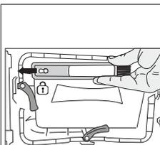
Tirare la spazzola verso sinistra per toglierla. Sarà possibile usare la spazzola di pulizia per pulire il filtro, la superficie metallica di condensazione e le fibre accumulate sulla porta.
