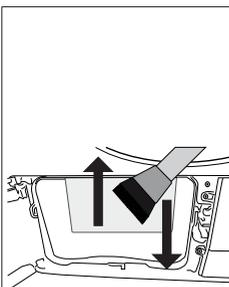
Pulire la fibra sulla superficie metallica del condensatore con un panno umido o la spazzola sul deflettore dell'aria in direzione su - giù. Non pulire in direzione destra-sinistra perché danneggia le piastre metalliche del condensatore.
