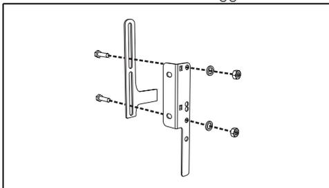
4. Allineare la base del gancio della staffa di fissaggio con la base del taglio della piastrina di fissaggio al muro.
