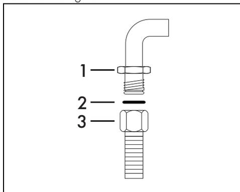
Avvitare accuratamente il raccordo 3 al raccordo gas 1 dell'apparecchio interponendo sempre la guarnizione 2 in dotazione.
