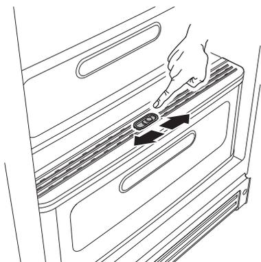
Utile per regolare l'umidità all'interno del cassetto frutta e verdura. Scorrere il regolatore in senso orizzontale per aprire o chiudere il passaggio d'aria attraverso le feritoie.
