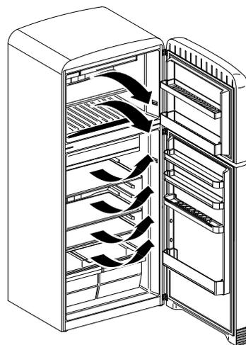
Il sistema di ventilazione interna sfruttato dalla tecnologia NO-FROST, permette di raffreddare i cibi più rapidamente e mantiene una refrigerazione omogenea all'interno dell'apparecchio.
