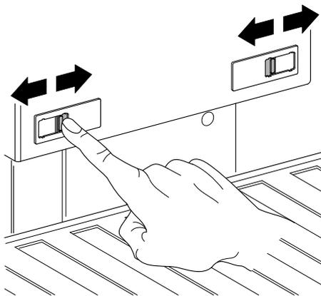
La temperatura dello scomparto super-freddo è regolabile tramite le due fessure a scorrimento presenti sulla parete posteriore dell'apparecchio.
