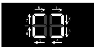
**Spegnimento dell'apparecchio:** tenere premuto a lungo (2 secondi) il tasto **A**. Il segnale acustico suona di nuovo e il display **B3** mostra l'illuminazione circolare in senso orario dei segmenti esterni. L'apparecchio è in modalità standby (ancora sotto tensione elettrica).
