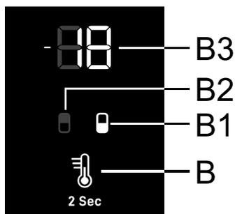
La temperatura del vano **congelatore** può essere impostata quando il simbolo **B1** è acceso. La temperatura viene impostata premendo brevemente il tasto **B**.
