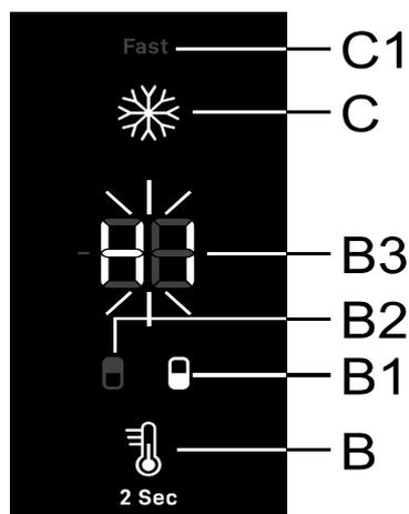
Quando la temperatura è troppo alta, suona l'allarme (**tono interrotto**), e sul display **B3** lampeggia HI, allo stesso tempo si illumina il simbolo del vano dell'apparecchio in cui la temperatura è troppo alta (**B1** o **B2**).
