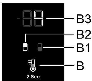
La temperatura nel vano **frigorifero** può essere impostata quando il simbolo **B2** è illuminato. La temperatura viene impostata premendo brevemente il tasto **B**.
