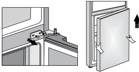
9. Posizionare lo sportello inferiore su una superficie liscia. Rimuovere la vite (8) e rimuovere il blocco a scatto dello sportello (10) e il fermo dello sportello (9). Quindi, con la vite (8) sul lato opposto dello sportello, fissare il blocco a scatto allegato nella busta e il fermo dello sportello (9). Conservare il blocco a scatto dello sportello (10) per un eventuale uso successivo.
