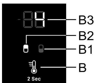
Con questo modello, è possibile passare dalla regolazione del vano frigorifero alla regolazione del vano congelatore. Per fare ciò, premere il tasto **B** per due secondi per illuminare il simbolo della parte dell'apparecchio di cui si desidera impostare la temperatura: **B1** per il vano congelatore e **B2** per il vano frigorifero.
