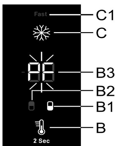
Se l'apparecchio si riscalda a una temperatura di allarme durante l'interruzione di corrente, l'allarme di alta temperatura si riattiva al ritorno della corrente elettrica. Viene emesso un allarme acustico e **PF** lampeggia sul display **B3**.
