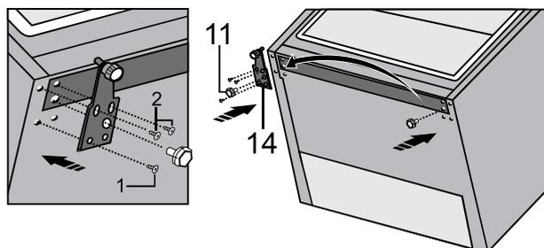
14. Posizionare lo sportello inferiore sul cardine inferiore e tenerla ferma. Ruotare il cardine centrale di 180°, posizionarvi la rondella e sistemare il cardine nella posizione corretta in modo da poter fissare lo sportello inferiore al suo posto.
