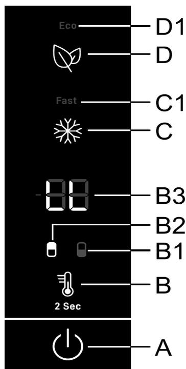
**Accensione:** per attivare il blocco bambini, tenere premuti per un tempo più lungo (2 secondi) i tasti **A** e **D**. Sul display **B3** appare brevemente **LL**.
