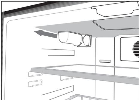
4. Posizionare il coperchio del filtro dell'acqua all'interno del meccanismo e premere per fissare in posizione.
