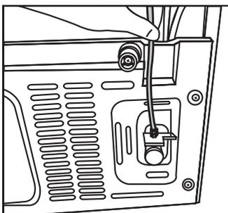
3. Serrare il connettore manualmente per fissarlo all'adattatore dell'ugello del tubo. Sarà inoltre possibile serrare il connettore servendosi di una pinza o di una chiave.
