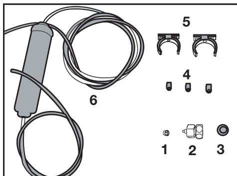
1. Connettore (1 pezzo): Usato per fissare il tubo dell'acqua alla parte posteriore del prodotto.
