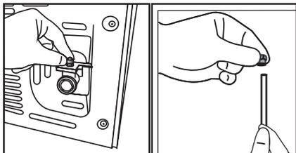
2. Premere saldamente il tubo dell'acqua verso il basso e collegare all'adattatore dell'ugello del tubo.
