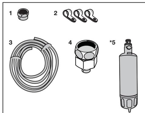
1. Connettore (1 pezzo): Usato per fissare il tubo dell'acqua alla parte posteriore del prodotto.
