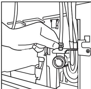
4. Collegare l'altra estremità del tubo alla presa dell'acqua (cfr. Sezione 3.7) o, per usare il serbatoio, alla pompa dell'acqua (Cfr. Sezione 3.8).
