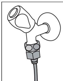
3. Fissare il connettore al tubo dell'acqua.
