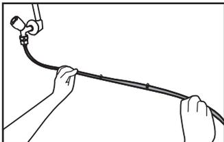
2. Collegare l'altra estremità del tubo della qua alla pompa della qua premendo il tubo nella presa di ingresso della pompa.
