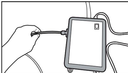
3. Posizionare e serrare il tubo della pompa all'interno del serbatoio.
