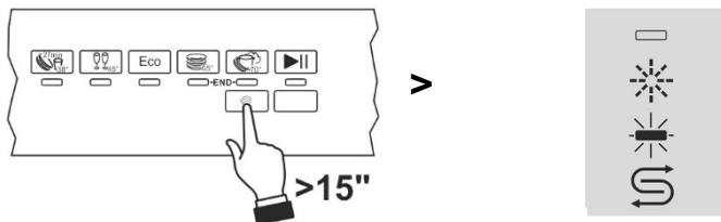
In seguito alla regolazione o alla visualizzazione di quella impostata è sufficiente lasciare inattivo il pulsante per alcuni secondi, la lavastoviglie ritorna automaticamente alla condizione standard uscendo dalla modalità di regolazione.
