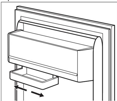
Questo modello è dotato di un contenitore a dimensione variabile per la conservazione che può essere spostato lateralmente.
