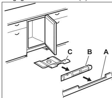
2. Pulire la griglia di ventilazione. (Fare riferimento alla sezione "Pulizia del filtro di ventilazione".)
