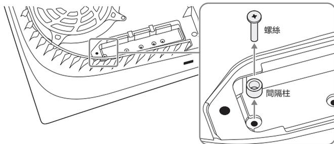
② 握住M.2 SSD的邊緣，將其對準擴充端子上的凹槽，然後從斜上方開始將其牢固地完全插到底。
