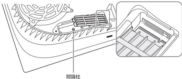
③ 向下傾斜裝好M.2 SSD，並用螺絲固定。
