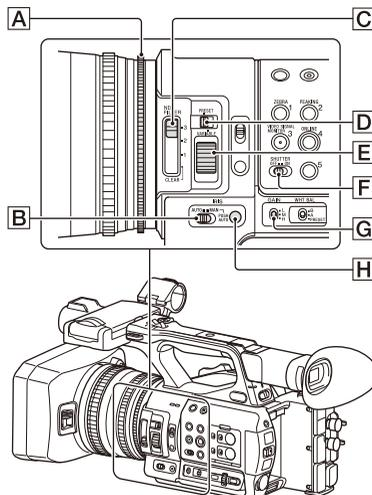
È possibile regolare la luminosità variando opportunamente i valori di diaframma, guadagno, velocità dell'otturatore, nonché regolando il livello di luce mediante i filtri ND.
