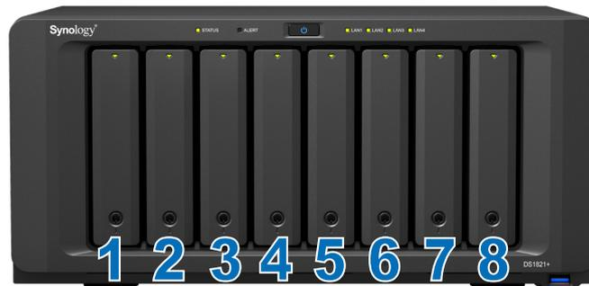
**Nota:** per creare un volume RAID, si consiglia di installare unità di dimensioni identiche per utilizzare al meglio le relative capacità.
