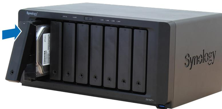
**Nota:** verificare che il vano unità sia completamente inserito. In caso contrario, l'unità potrebbe non funzionare correttamente.
