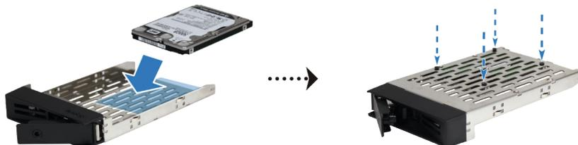
3 Inserire il vano dell'unità caricata nel vano vuoto dell'unità.
