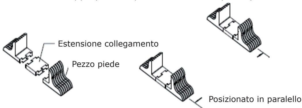
Schema di montaggio componenti piedini
