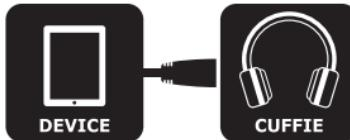
1. Conecte los auriculares inalámbricos a cualquier dispositivo equipado con un puerto AUX con el cable AUX a AUX.
