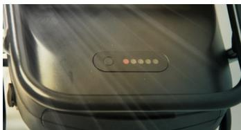
Ricordare di caricare la batteria completamente prima di avviarsi per un lungo viaggio! Premere il pulsante posto sulla parte superiore della batteria, quando i 4 led sono di colore verde la batteria è carica (Fig. 6.2)
