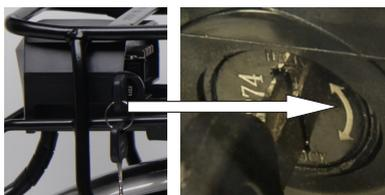
Dalla posizione iniziale (ore 12), premere la chiave e ruotare in senso orario in posizione ore 6 per effettuare il bloccaggio. Effettuare il procedimento inverso per lo sbloccaggio.
