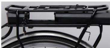
La e-bike ha la batteria posizionata all'interno del portapacchi (la batteria è direttamente collegata alla unità di controllo nella parte anteriore (fig. 2).
