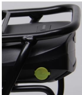
Se una presa di corrente è vicina alla batteria, è possibile ricaricare la batteria lasciandola direttamente attaccata alla bicicletta stessa. La porta di ricarica è coperta da un cappuccio di plastica verde (Fig. 4.3), è sufficiente aprirla per mettere in carica la batteria direttamente (Fig. 4.4).
