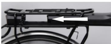
La custodia della batteria è bloccata dalla chiave (fig. 4.1 e 4.2), vedere i dettagli nelle immagini sottostanti.
