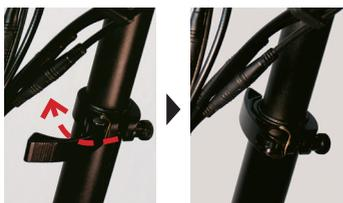
La leva di blocco dello stelo del manubrio è dotata di un cursore di blocco che impedisce l'apertura accidentale della medesima e la conseguente rotazione del manubrio; la funzionalità di questo cursore deve essere verificata prima di ogni utilizzo onde evitare pericoli per l'incolumità dell'utente.
