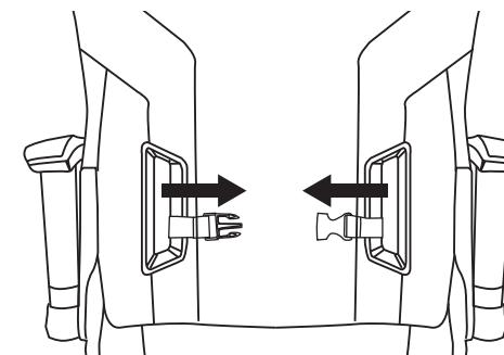
ES 1. Tire de las correas a través de los orificios del cinturón para los hombros y encájelas en su posición.
