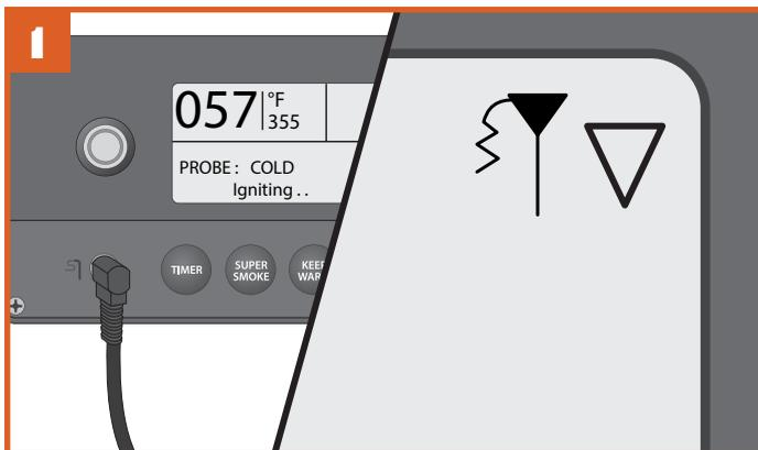
Inserire la sonda nella relativa presa del controller WiFIRE. Vedere “Uso del barbecue” per accendere il barbecue. Una volta acceso il barbecue, il controller riconosce la sonda e si accende l'icona della sonda nell'angolo superiore destro dello schermo del controller.
