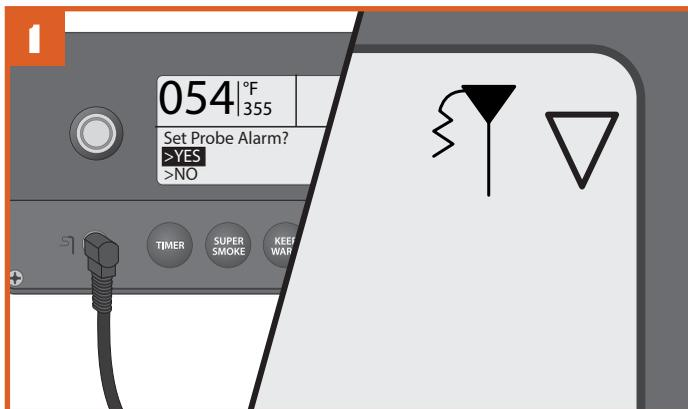
Inserire la sonda nella relativa presa del controller WiFIRE. Il controller riconosce la sonda; si accende l'icona della sonda nell'angolo superiore destro dello schermo del controller. Il sistema chiede se si desidera impostare un allarme della sonda. Selezionare YES (sì).
