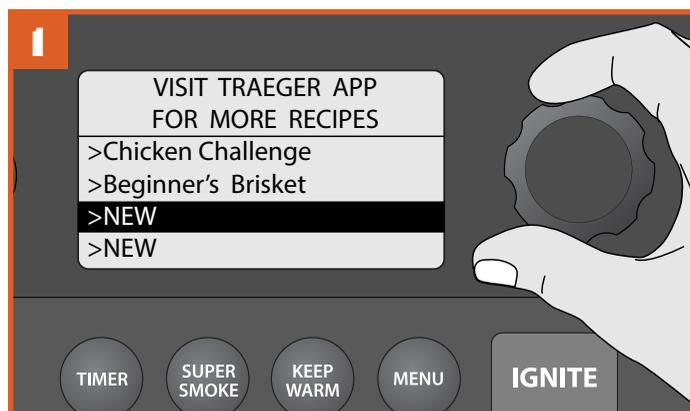
Nel menu Cook Cycle (programma di cottura), selezionare NEW (nuovo) per visualizzare il menu delle fasi di cottura.
