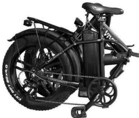
Da telaio chiuso (Fig. 1) afferrare la sella e il manubrio e ruotare la metà anteriore del telaio in avanti attorno al cardine finché le due parti non si trovano in asse.
