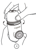
4 Parafuse de volta firmemente a cabeça de saída para perfurar a cápsula.
