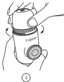
④ Schrauben Sie den Auslasskopf wieder fest, um die Kapsel durchzustechen.
