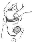
④ 尽力拧紧出水端以刺穿胶囊
