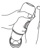
Les 8 premiers coups la pression est construite. Pompez lentement jusqu'à ce que tout le café sortir.
