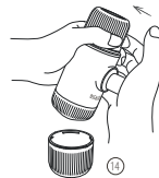
14 Sostenga el Nanopresso con dos manos, como se mostró arriba. Comience a bombear por encima de una taza. Las 8 primeras presiones llenarán el filtro canastilla de agua. Continúe bombeando hasta que deje de salir café.
