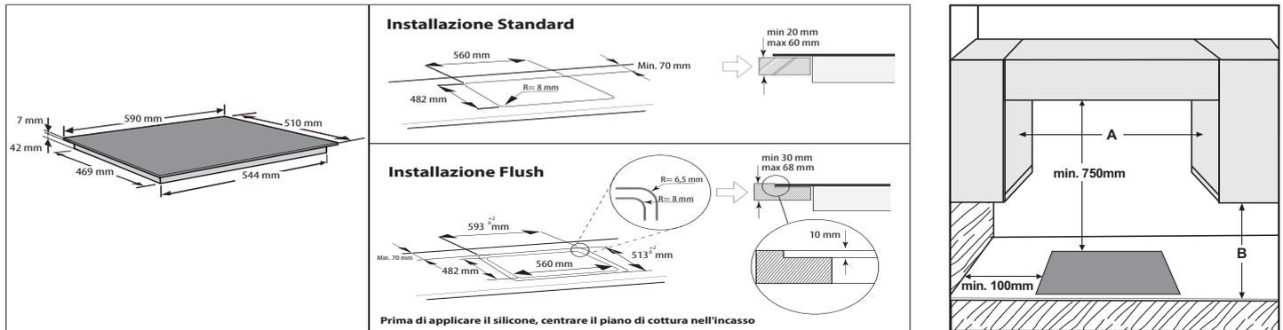
**NOTA:** se la distanza "A" tra i pensili è compresa tra 600 mm e 730 mm, l'altezza "B" deve essere minimo 530 mm. Se la distanza "A" tra i pensili è maggiore della larghezza del piano di cottura, l'altezza "B" deve essere minimo 400 mm. Qualora venga installata una cappa sopra il piano di cottura, fare riferimento alle istruzioni di montaggio della cappa per la distanza da rispettare.
