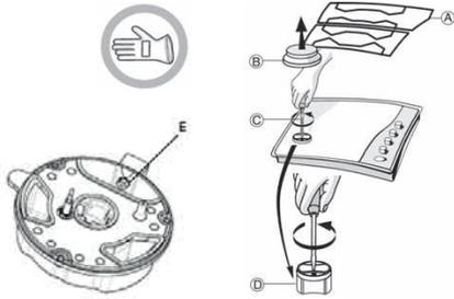
Prima di installare il piano di cottura, ricordarsi di applicare la targhetta di taratura gas fornita con gli iniettori di ricambio, in modo che copra le informazioni già presenti.
