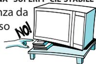
Collocare il forno lontano da altre sorgenti di calore. Per garantire una ventilazione sufficiente, ci deve essere uno spazio di almeno 30 cm sopra il forno. Assicurarsi che lo spazio sotto, sopra ed intorno al forno sia libero per consentire un'adeguata circolazione dell'aria. Il forno a microonde non deve essere collocato in mobili ad incasso. Questo forno non è destinato ad essere collocato o utilizzato su una superficie di lavoro che si trovi ad un'altezza inferiore a 850 mm dal pavimento.
