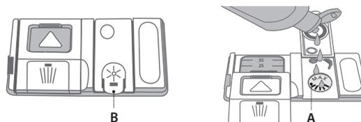
2. Versare delicatamente il brillantante fino al segno che indica il livello di riferimento massimo (110 ml), ma evitandone la fuoriuscita. Nel caso in cui ciò si verifici, asciugare immediatamente il liquido fuoriuscito mediante un panno asciutto.
