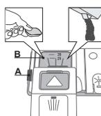
**per aprire il distributore detersivo utilizzare il dispositivo di apertura A.**
