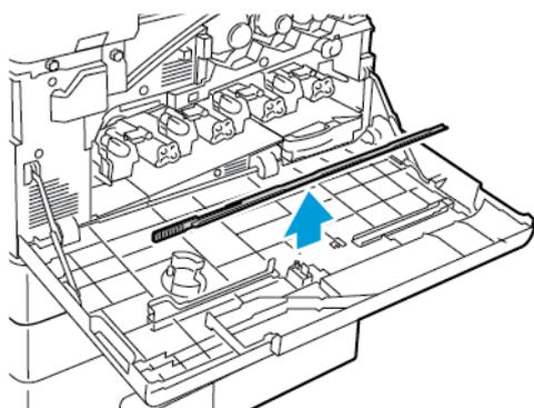
4. Per la prima testina di stampa, inserire lentamente l'asta di pulizia nel vano di pulizia della lente LED della testina di stampa fino al punto di arresto, quindi estrarre l'asta. Ripetere questa operazione due o tre volte.
