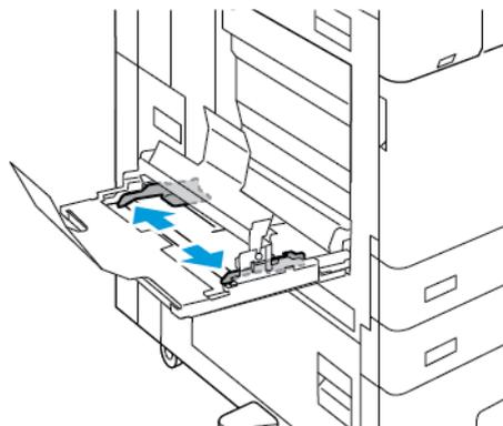
3. Caricare i fogli di intestazione nel vassoio. Caricare la carta sulla guida posteriore dell'estensione per alimentazione fogli lunghi con il lato corto alimentato per primo nella stampante. Assicurarsi che il bordo anteriore passi sotto la guida anteriore.
