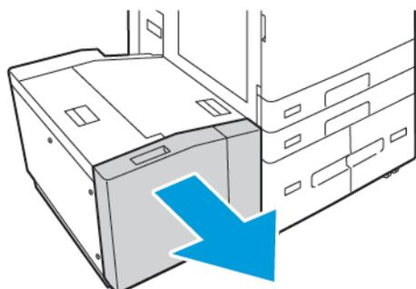
2. Aprire lo sportello laterale. Rimuovere la vite di fissaggio della piastra spaziatrice sul retro del vassoio, quindi sollevare la piastra spaziatrice e rimuoverla dal vassoio. Ripetere la procedura per la piastra spaziatrice sulla parte anteriore del vassoio.
