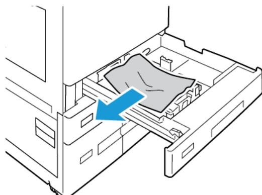
4. Se la carta è strappata, rimuovere completamente il vassoio e controllare che non siano rimasti dei frammenti all'interno della stampante.
