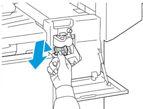
5. Controllare se all'interno della stazione di finitura sono rimasti dei punti metallici e rimuoverli.
