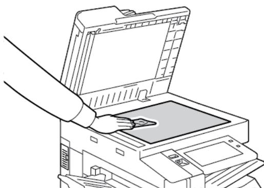
5. Strofinare il lato inferiore della copertura finché l'area non è pulita e asciutta.
