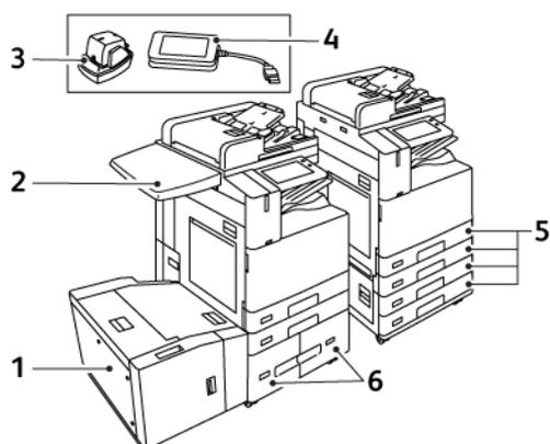
1. Vassoio 6: Alimentatore ad alta capacità
